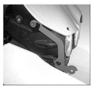
Fissate le staffe laterari utilizzando la vite con quandro sottotesta M5x10, la rondella D15 f5 Sp1 e il dado autobloccante M5 centrando il foro superiore del cruscotto.
