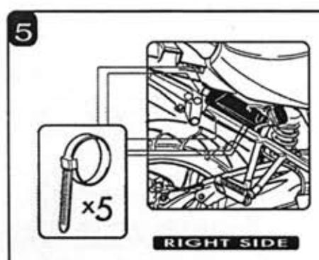
Verificare il corretto posizionamento del tubo del serbatoio e serrare a fondo le rimanenti fascette.
