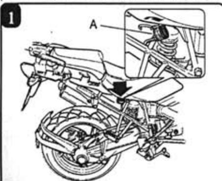
Sganciare il serbatoio dell'olio del freno posteriore (A).
