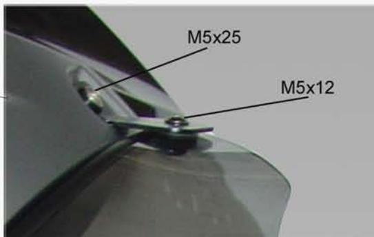
svitate la vite originale e rimuovete la clip all'interno della carrozzeria inserite il gommino ad espansione all'interno del foro richiudete la carena e fissate la piastrina porta laterale con la vite M5x25 TB a brugola. fissate il laterale alla staffa per mezzo della vite M5x12 e il dado speciale tornito a brugola
